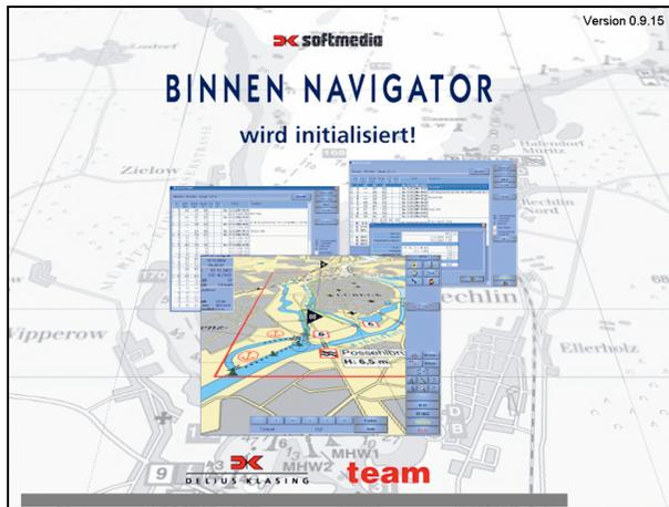
Der **BINNEN NAVIGATOR** führt die Initialisierung des Computers durch und sucht nach dem Signal des GPS-Empfängers. Wenn ein GPS-Signal gefunden wird, schaltet der Kartenplotter automatisch in den Navigationsbetrieb. Wenn kein GPS-Signal gefunden wird, endet der Suchvorgang nach einigen Sekunden automatisch.
