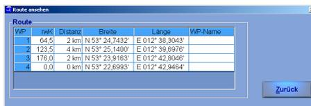
Die erstellte Route kann unter einem frei zu vergebenden Namen abgespeichert werden
