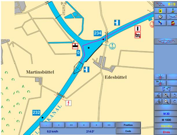
In der Koppelnavigation kann der **BINNEN NAVIGATOR** genauso genutzt werden wie bei der Navigation mit einem GPS-Empfänger. Die Funktionalität
