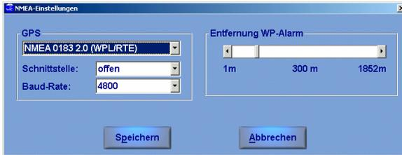
In dieser Maske sind der NMEA-Standard, die serielle Schnittstelle an Ihrem PC, über welche der GPS-Empfänger angeschlossen ist, und die Baud-Rate zu wählen. NMEA-Standard und Baud-Rate entnehmen Sie bitte der Dokumentation Ihres GPS-Empfängers.
