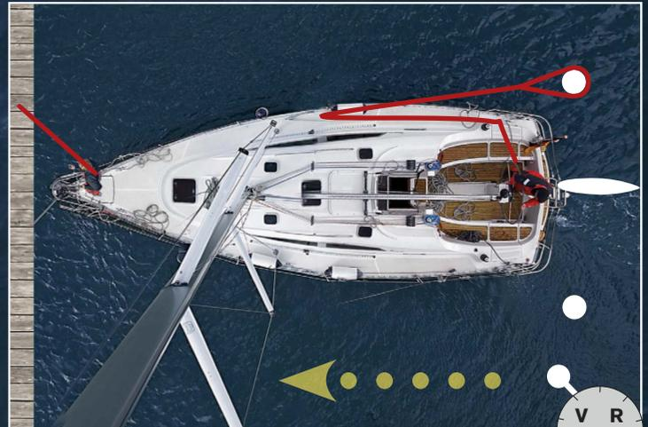
**3** Durch Fieren der Mittelspring die Yacht an den Steg führen. Der Vorschiffsmann bringt die Luv-Vorleine aus.
