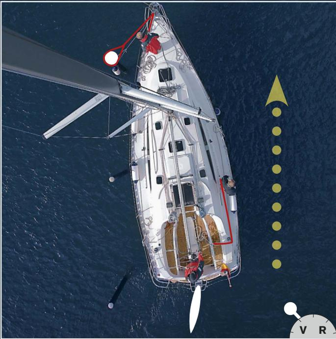
**1** Das Boot vorwärts am Pfahl vorbeischieben. Die Vorleine, jetzt eine Vorspring, wird von der Person am Bug kontrolliert über die Klampe gefiert. Wenn der Steuerbord-Pfahl fast erreicht ist, die Vorspring festsetzen. Ruder hart Backbord, Schub voraus.
