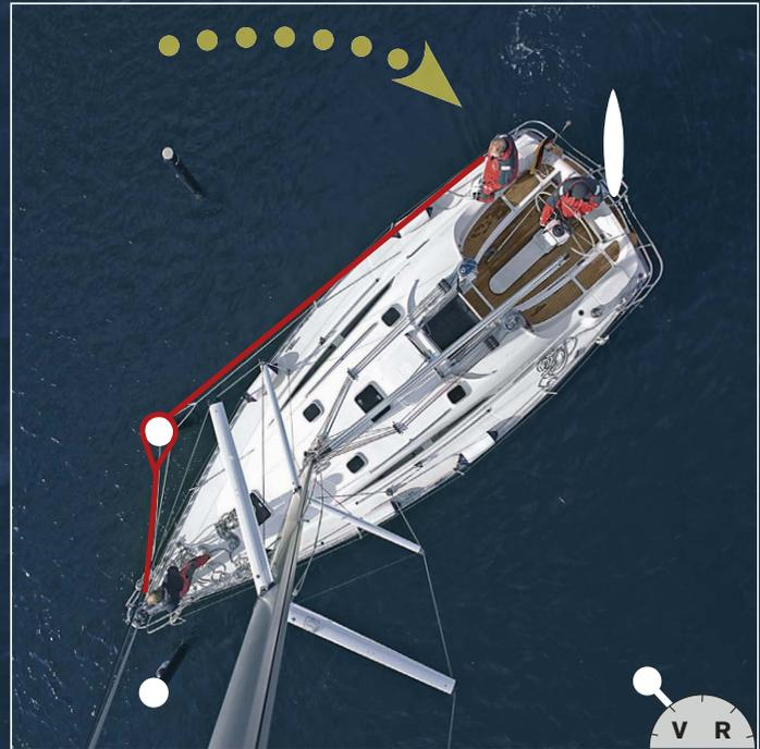
**2** Das Ruder Steuerbord legen und leichten Schub voraus geben – die Drehung des Hecks beginnt. Der Steuermann kontrolliert mittels Ruderlage und Schub die Drehgeschwindigkeit. Mit Backbord-Ruder und viel Gas könnte er die Drehung stoppen.
