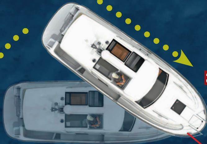
**1** Boote mit Wellenantrieb, die sich nur schlecht über das Heck steuern lassen, können das gleiche Manöver auch über den Bug fahren – mit dem Vorteil, dass die Plicht später windgeschützt ist. Der Skipper muss jedoch gut abschätzen können, wie dicht er sich dem Steg nähern kann, ohne dass Kollisionsgefahr besteht.
