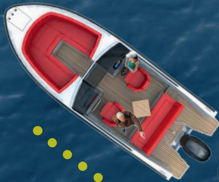
**1** Boote mit steuerbarem Antrieb lassen sich auch über Heck gegen den Wind an den Liegeplatz bringen. Der Strom darf allerdings nicht zu stark sein, da sonst mit mehr Schub gearbeitet werden muss und Wasser überkommen kann. Der Anlauf erfolgt rückwärts mit gerade so viel Fahrt, wie zum Manövrieren nötig ist.
